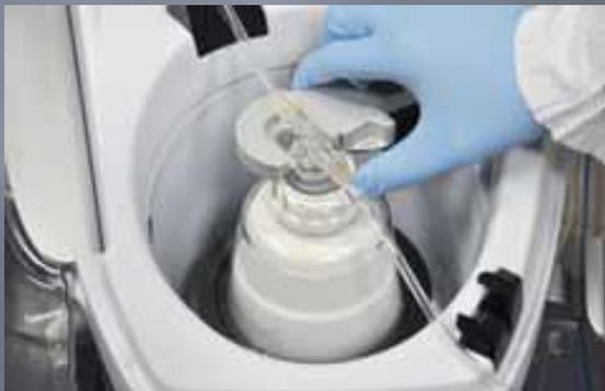
Новая конструкция верхней панели системы Xtra позволяет выполнить безошибочную загрузку расходных материалов
