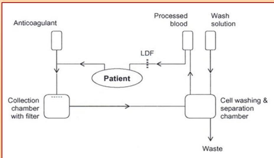
Рис. 1. Схематическое представление системы по реинфузии крови
